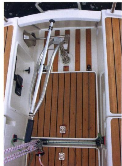
Der eingehakte Bügel (hinten an der Pinne) lenkt um zum Innen-Steuerstand
