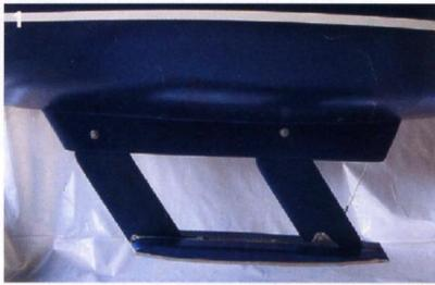
1.) Der PSK Parallel-Schwingkiel halbiert den Tiefgang im aufgeholtem Zustand – bei immer noch ausreichender Stabilität. Er lässt sich über eine Kurbel am Niedergang fieren oder aufholen. 2.) Fallen und Strecker sind ins Cockpit umgelenkt und verschwinden dann in einem ins Süll eingelassenen Staufach. 3.) Der optionale Diesel ist durch eine Luke im Cockpit-Boden einfach zu erreichen und zu warten
